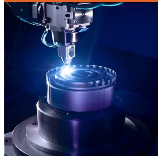
„Lasersäge“ ermöglicht die hochpräzise Bearbeitung empfindlicher Materialien, zum Beispiel für die Knochenchirurgie
